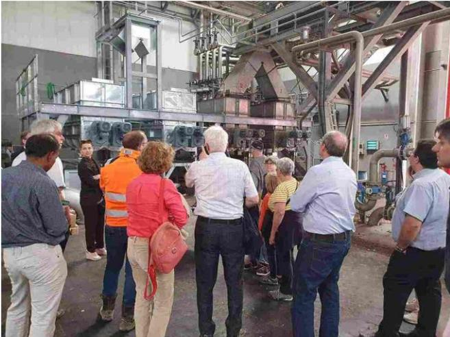
Dans la halle, « la recette » est d'abord broyée dans le Broyeur, puis mélangée dans le Mélangeur avec du Digestat liquide provenant du Post-Digester.
