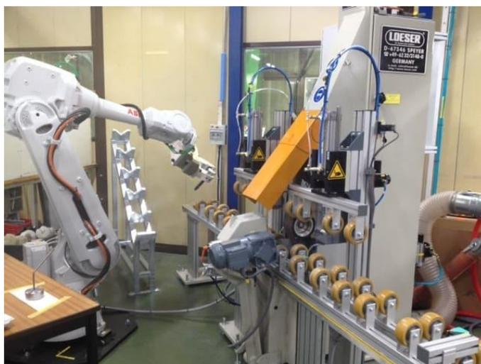
**Figure 29.** Utilisation de robot pour le chargement et déchargement de pièces par Kalistrut Aerospace
