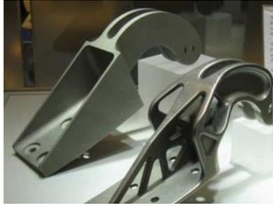
**Figure 20.** *Fabrication additive de la charnière de nacelle en titane avec la pièce optimisée à droite (source Airbus group)*
