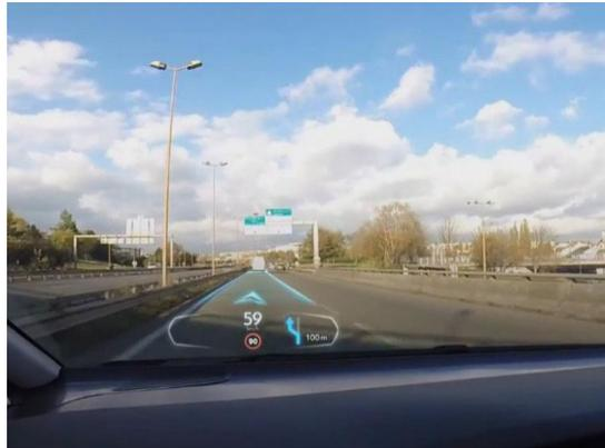
**Figure 13.** La réalité augmentée chez PSA pour informer le conducteur des informations relatives à la conduite
