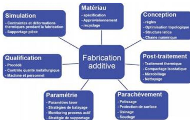
**Figure 18.** Démarche du développement produit par la fabrication additive (source Liebherr)
