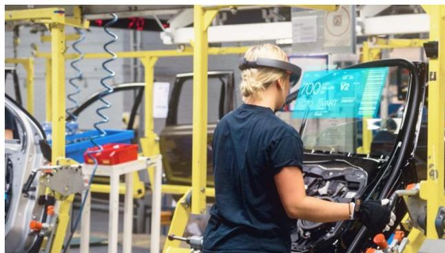
**Figure 14.** Réalité mixte pour assister l'opérateur dans l'opération du montage (Artefacto)
