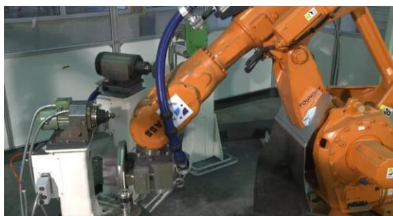
**Figure 24.** Robot de parachèvement développé par le Cetim et CTIF (©Cetim)
