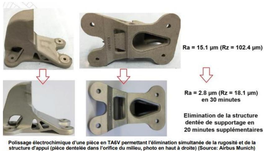
**Figure 17.** Polissage d'une pièce en TA6V (source Airbus Munich)
