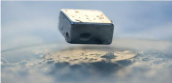
Lévitacion d'un aimant placé au dessus d'une pastille de supraconducteur refroidie dans de l'azote liquide à  $-196^{\circ}\text{C}$ .
