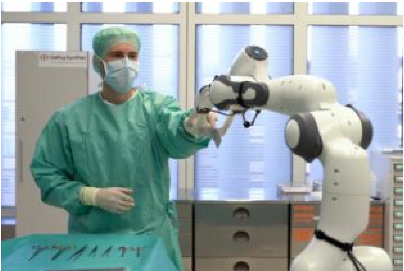
Handreichung für den Arzt: In München werden Assistenzroboter im Operationssaal erprobt. Neben einer Variante für nicht sterile Produkte (im Bild) wird auch an einem Roboter für sterile Anwendungen geforscht.
