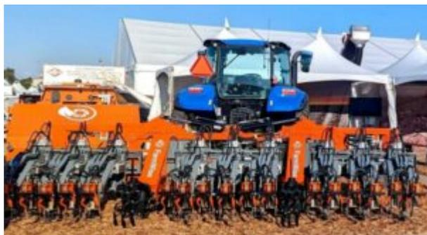
Der Roboter „Vulcan“, entwickelt am Massachusetts Institute of Technology (MIT), macht Unkräutern den Garaus. Landwirte sparen Arbeit und Pestizide. Das Gerät wird von einem Traktor gezogen, der allerdings noch
