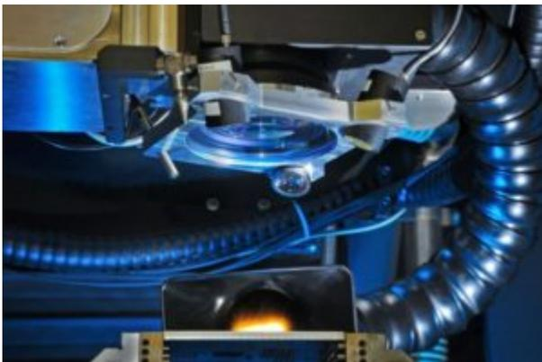
Neue Freiheiten eröffnen sich in der Lasermaterialbearbeitung: Mit einem Flüssigkristall-Modulator lässt sich das Strahlprofil eines Lasers zeitlich hochaufgelöst frei programmieren. Der Strahl kann auch in identische Kopien
