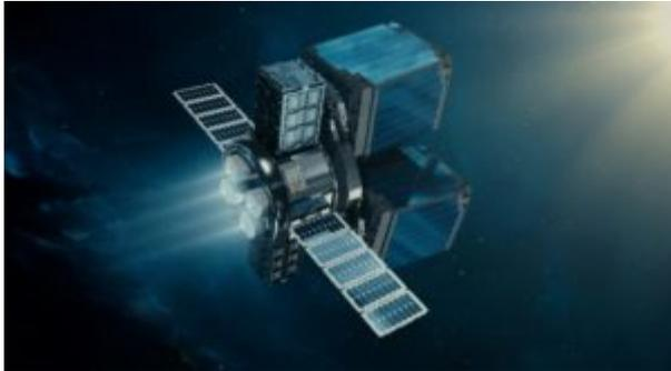
Das Berliner Unternehmen Exolaunch entwickelt ein orbitales Transportvehikel (OTV), das in einer Mission Satelliten aussetzen und Schrottteile einsammeln kann. Die Space-Tug-Variante
