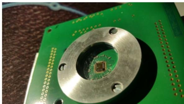
**Figure : Dessin des masques et photographie du capteur imageur à balayage de fente réalisé par l'équipe SMH**
