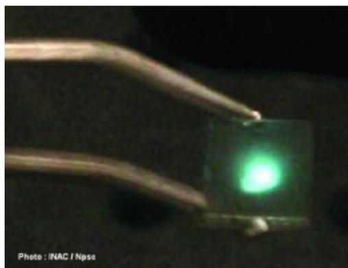
La lumière émise dans ce bloc est l'œuvre d'un nano-émetteur. © J.Eymeru/INAC Grenoble
